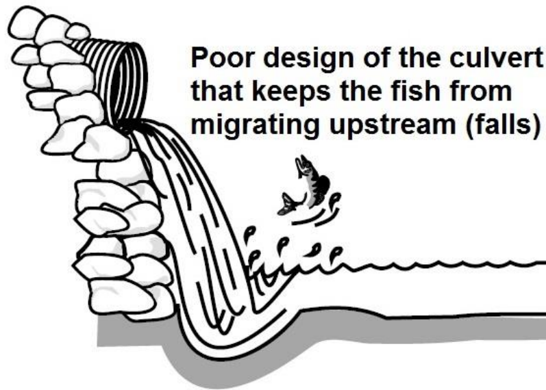
Figure 103: : Poor design of the culvert (Source : Bibliothèque nationale du Québec, 1997 )
